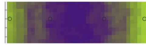
AUTONOMIE EN LUMIÈRE NATURELLE (400 LUX) - PLAN (AUTONOMIE ANNUELLE 90 % DE 8H30 À 17H30)
