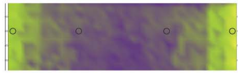
NIVEAU D'ÉCLAIRAGE NATUREL À 800 mm DU PLANCHER / STORE OUVERT- PLAN
